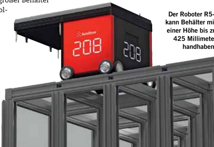
Der Roboter R5+ kann Behälter mit einer Höhe bis zu 425 Millimeter handhaben.
