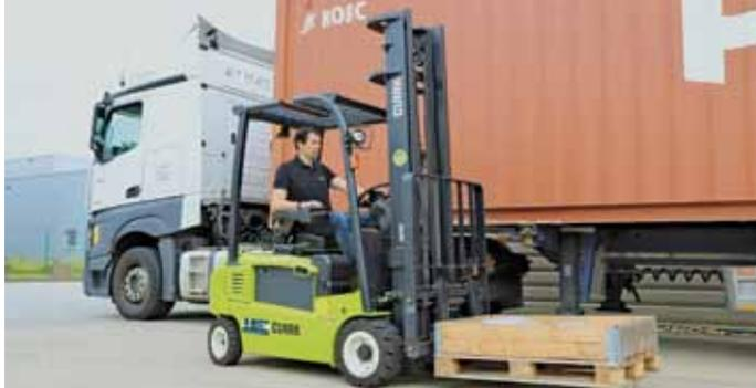
Die Elektro stapler GEX- und GTX sind Clarks erste Gegengewichtsstapler mit Li-Ion-Batterie.
