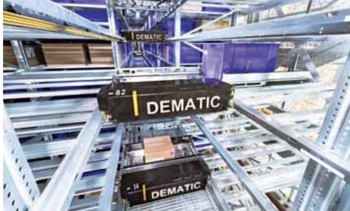
platzsparende mehrfache Lagerung ermöglicht. Die Intralogistiklösung lagert die Artikel mithilfe von 85 Shuttles automatisch ein, puffert und sequenziert diese und transportiert sie zu acht Kommissionierstationen. Geplant ist, dass die Anlage
